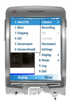
Ist die ausgewählte Kamera eine PTZ-Kamera, lässt sich diese über das Menü steuern. Dabei können bspw. auch vordefinierte Positionen angefahren werden.
